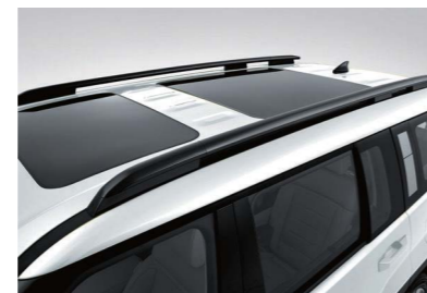
Krovni nosač tipa mosta / dvostruki krovni otvor
